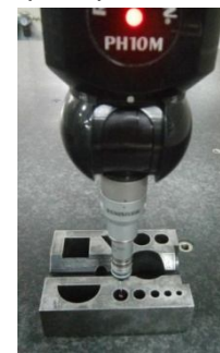
Gambar 2. Pengukuran posisi koordinat lingkaran dua dimensi
